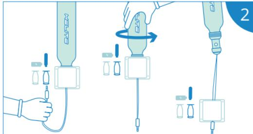
**3. Remueva el aire del chaleco con ambas manos.****4. Instale un nuevo cilindro electrónico.**
